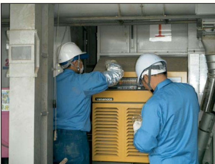
【機械表面の汚染測定の様子】
