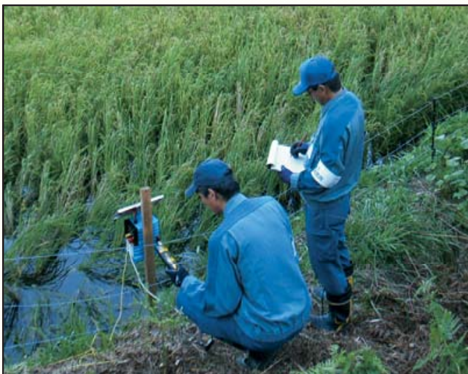
電気柵の電圧測定【平成25年9月17日】
